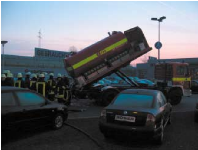
Wechsellader mit AB-Schaum der BF Dortmund in Arbeitsstellung.
